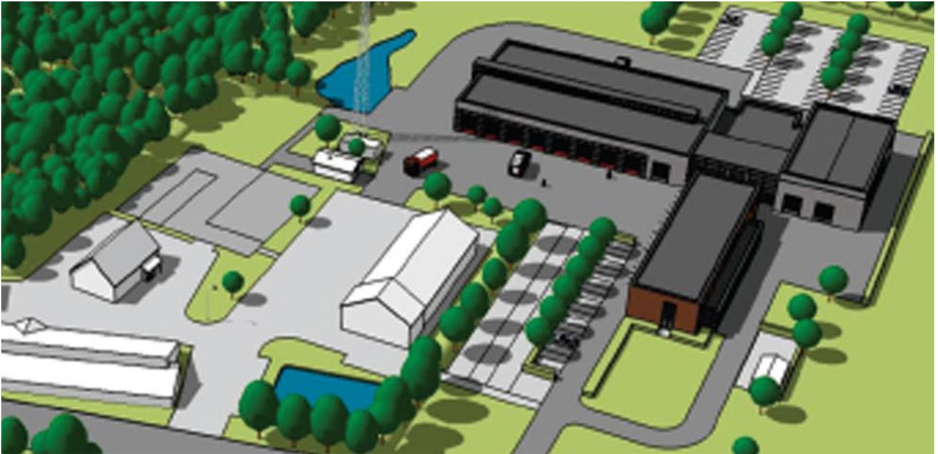
So soll der Neubau einmal aussehen. Die neue Fahrzeughalle hat Ausfahrten zu beiden Seiten, rechts Außen ist die Kfz-Werkstatt. Der hinter die jetzige ABC-Halle reichende Mittelteil wird gehört zu einem zweiten Bauabschnitt. Vorne links auf der Zeichnung liegt das Schulungszentrum. Über dem Atemschutzübungshaus entsteht der neue Übungsplatz.
